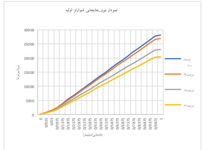
شکل ۳- نمودار نیرو-جابجایی سازه شوارتز اولیه در درصد های مختلف حجم در بهینه سازی هندسه
